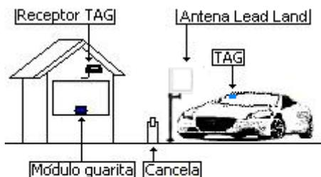
Notar que a onda de alta freqüência (915Mhz) é direcional, sendo emanada com total intensidade para frente e nunca para trás da antena iluminadora. O tag é sensível ao posicionamento no veículo, sempre fixado no sentido horizontal.
