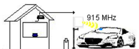
Com a aproximação de um veículo com um Tag posicionado corretamente é iniciada a autenticação. Se dentro do campo de ação da Antena iluminadora, a energia emanada pela mesma ativa o chip do Tag que retransmite a informação cadastrada no mesmo identificando assim o usuário.
